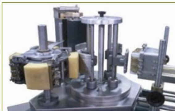
Las etiquetas se colocan en una caja porta-etiquetas ubicada sobre una plataforma fija.
