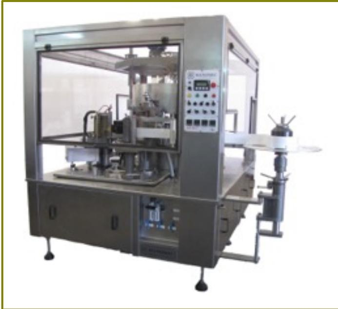
Los envases a etiquetar ingresan desde la cinta transportadora a la maquina mediante un sistema de estrella de acompañamiento que los ubica en los puestos giratorios ubicados sobre el plato central. Simultáneamente al ingreso, descienden sobre estos los conos centradores que se apoyan sobre los picos de los envases, presionándolos sobre las arandelas antideslizantes.
