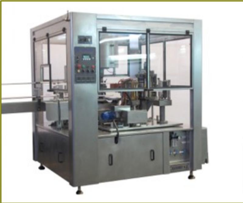
Las bidones son introducidos automáticamente desde una cinta transportadora; cada bidón al ingresar, envía por intermedio de un circuito, una señal al sistema de cuchillas, habilitando el corte del film; el cual posee en su trayecto desde la bobina, un brazo compensador, para la absorción de los efectos de inercia; en la detención o puesta en marcha del film.
