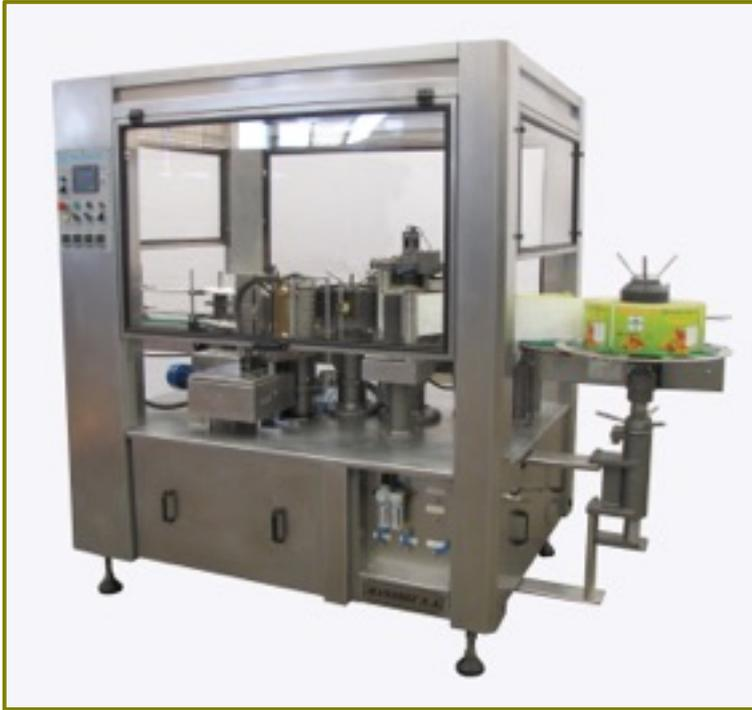
Esta maquina permite el etiquetado envolvente de envases cilíndricos con delgadas hojas de plástico provenientes de una bobina, que otorga una gran reserva de etiquetas, asimismo un consumo reducido de adhesivo, pues el mismo se aplica solamente en los extremos, y es del tipo Hot Melt. (encolado con cola caliente).
